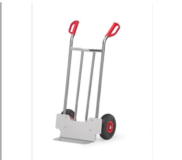
Aus Aluminiumrohr mit Aluminiumschaufel, sehr leicht und handlich. Sauber verschweißt und "naturbelassen", Alublechschaufel anschraubbar und dadurch austauschbar. Wahlweise mit Vollgummi- oder Luftbereifung auf Kunststoff-Felgen, Naben mit Rollenlagerung. Bügel oben und Querstreben durchgebogen. Für den sicheren Transport von runden Gütern, wie Rollen, Kannen, Eimern usw.
