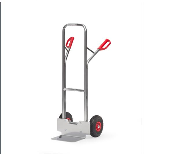
Aus Aluminiumrohr mit Aluminiumschaufel, sehr leicht und handlich. Sauber verschweißt und "naturbelassen", Alublechschaufel anschraubbar und dadurch austauschbar. Wahlweise mit Vollgummi- oder Luftbereifung auf Kunststoff-Felgen, Naben mit Rollenlagerung. Bügel oben und Querstreben durchgebogen. Für den sicheren Transport von runden Gütern, wie Rollen, Kannen, Eimern usw.
