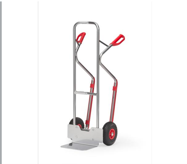
Aus Aluminiumrohr mit Aluminiumschaufel, sehr leicht und handlich. Sauber verschweißt und "naturbelassen", Alublechschaukel anschraubbar und dadurch austauschbar. Wahlweise mit Vollgummi- oder Luftbereifung auf Kunststoff-Felgen, Naben mit Rollenlagerung. Bügel oben und Querstreben durchgebogen. Für den sicheren Transport von runden Gütern, wie Rollen, Kannen, Eimern usw.
