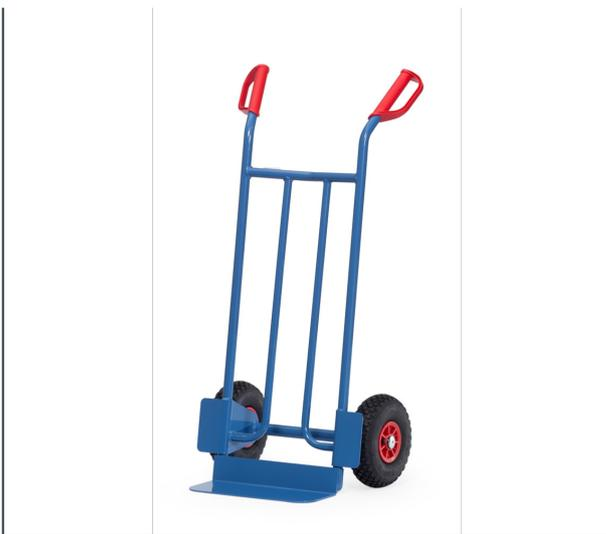
Handlich, mit Stahlblechschaufel, stabile Schweißkonstruktion, pulverbeschichtet, blau, RAL 5007. Sicherheitsgriffe. Stahlblechschaufel anschraubbar und dadurch austauschbar. Räder wahlweise mit Vollgummi- oder Luftbereifung, auf Kunststoff-Felgen, Naben mit Rollenlagerung. Zerlegte Anlieferung.
