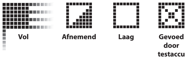
Indicator voor het laadniveau van de AA-batterijen
